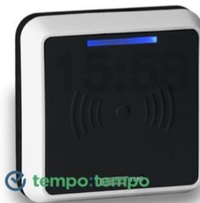
Gli ST065 sono testine di lettura principalmente utilizzate nel settore del controllo accessi come punto di rilevazione della tessera in prossimità del varco pilotato dalla scheda ST-FDNEO o dalla centralina ST-DOOR o ST-GATE.
